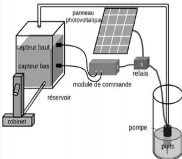
Lorsque le niveau de l'eau dans le réservoir atteint le capteur haut, l'ordre est donné d'arrêter la pompe.
